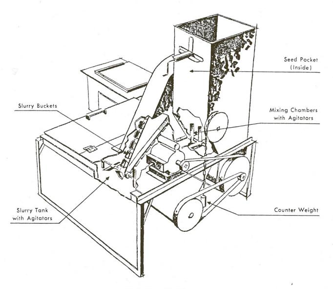
Fig. 1: Slurry Seed Treater
